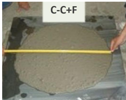
Сл. 4. Разливање слијегањем бетонске мјешавине пројектоване са кречњачким брашном и електрофилтерским пепелом
